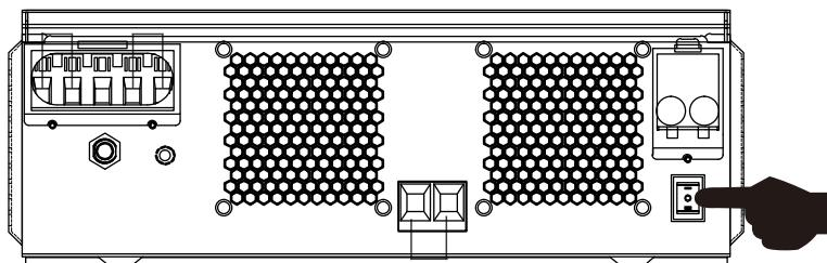
После окончания монтажа и правильного подключения батарей, просто нажмите клавишу Вкл/Выкл в нижней части устройства для включения ИБП.
