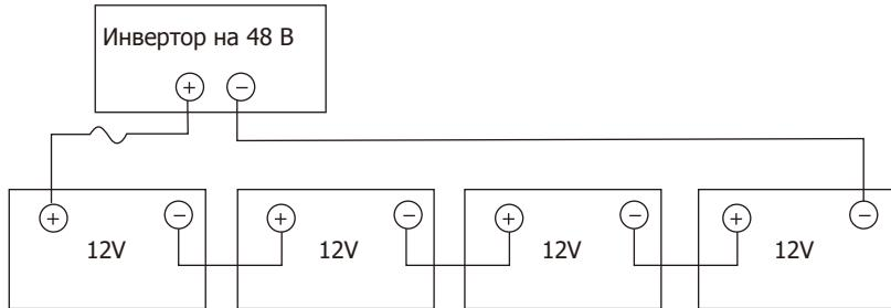
3. Плотно затяните болты батарейных клемм (усилие затяжки 2-3 Н·м). Неплотный контакт под нагрузкой может привести к разогреву соединений и повреждению инвертора.
