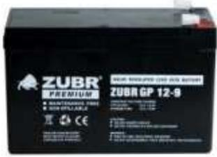
Аккумуляторная батарея ZUBR серии GP - аккумулятор общего назначения со сроком службы 5 лет в буферном режиме или более 260 циклов при 100% разряде в циклическом режиме. Аккумуляторная батарея является перезаряжаемой, высокоэффективной, герметичной и нетребующей обслуживания
