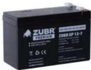
Аккумуляторная батарея **ZUBR** серии **GP** - аккумулятор общего назначения со сроком службы 5 лет в буферном режиме или более 260 циклов при 100% разряде в циклическом режиме. Аккумуляторная батарея является перезаряжаемой, высокоэффективной, герметичной и не требующей обслуживания
