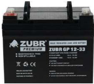
Аккумуляторная батарея ZUBR серии GP - аккумулятор общего назначения со сроком службы 10 лет в буферном режиме или более 260 циклов при 100% разряде в циклическом режиме. Аккумуляторная батарея является перезаряжаемой, высокоэффективной, герметичной и не требующей обслуживания
