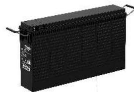
**WBR серии TPL121650** - герметизированные, выполненные по технологии AGM, батареи с фронтальным расположением выводов и сроком службы 12 лет при 25°C. Способность разряда большим током за короткий промежуток времени (до 30 мин) позволяет использовать эти батареи максимально эффективно в системах бесперебойного питания (UPS).
