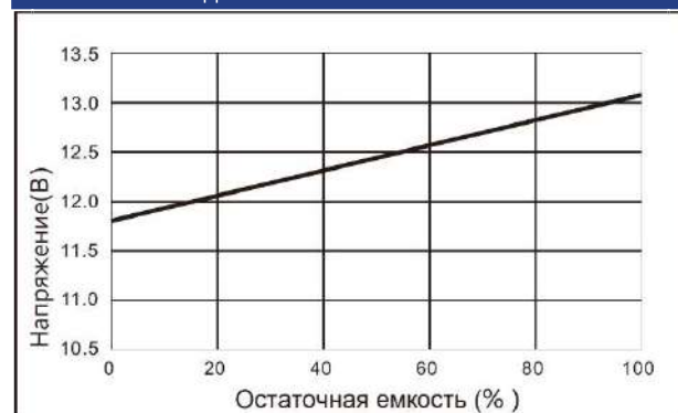
ЗАВИСИМОСТЬ ОСТАТОЧНОЙ ЕМКОСТИ ОТ НАПРЯЖЕНИЯ ХОЛОСТОГО ХОДА
