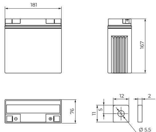
Габариты аккумуляторов находятся в допусках +/- 1мм.
