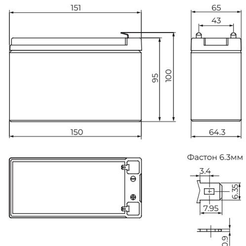
Габариты аккумуляторов находятся в допусках +/- 1мм.
