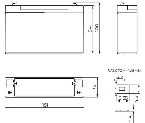
Габариты аккумуляторов находятся в допусках +/- 1мм.
