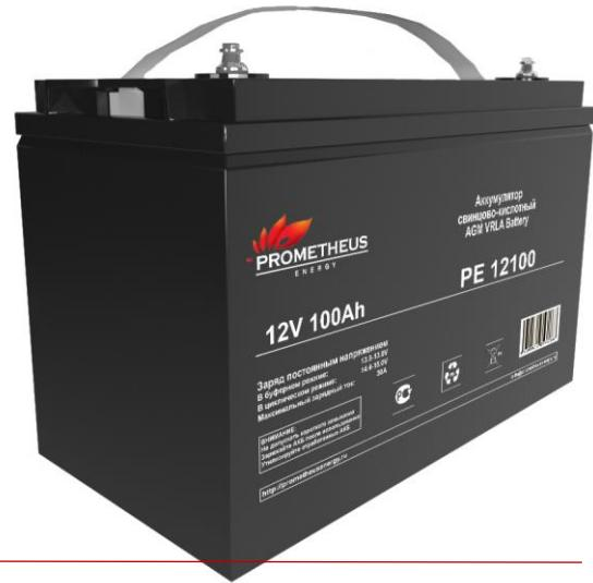
Свинцово-кислотные аккумуляторы **Prometheus Energy** серии РЕ являются ярким примером герметизированных, необслуживаемых батарей с системой рекомбинации газов (VRLA), произведенных по AGM технологии (электролит, абсорбированный в стекловолоконном сепараторе)
