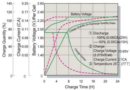
**Напряжение и время заряда в циклическом использовании**
